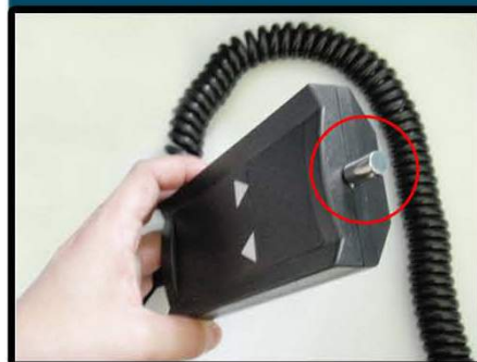
Si se extrae el switch del mando éste no funciona, evitando posibles accidentes o un uso no deseado
