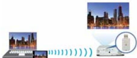
La conectividad Ethernet<sup>\*5</sup> permite controlar y supervisar el proyector y mostrar el contenido a través de la red LAN, mientras que la conexión inalámbrica opcional<sup>\*6</sup> permite mostrar contenido fácilmente a través de una amplia gama de equipos, incluidos tablets y smartphones con iOS y Android.
