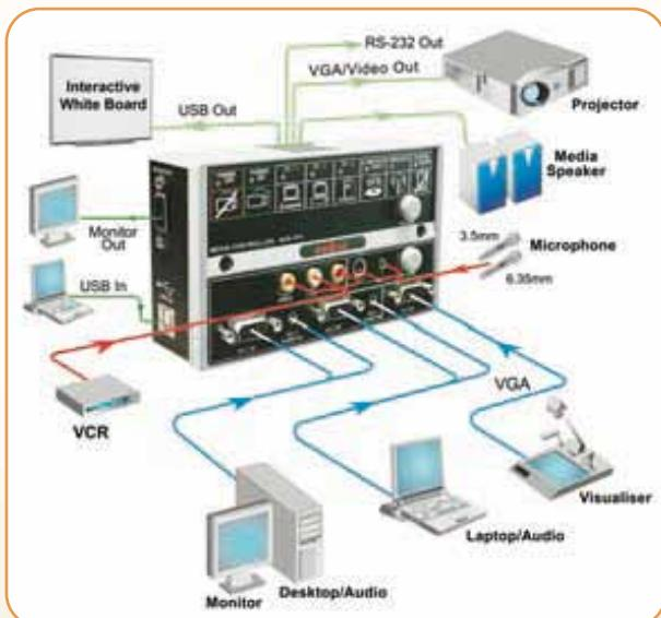
El controlador multimedia **AVS-311** de Abtus es uno de los sistemas de control más fáciles de instalar y utilizar por el usuario. Específicamente diseñado para adaptarse a cualquier sistema de proyección audiovisual. **Elimina la necesidad de múltiples mandos a distancia.**
